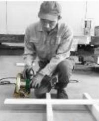
丸ノコのベースプレートを木材に触れさせないために丸ノコは両手で持って作業をする。
